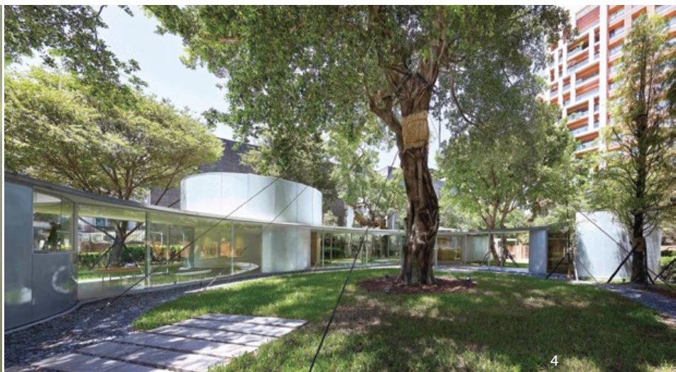
3. 半戶外廊道的設立，模糊了室內外的界線。4. 由於有多棵政府列管保護之老樹，建構接待中心時，便利用鋼索維持樹木穩定度，並以稻草包覆樹皮，以達保護作用。5. 平面圖。6. 室內軟裝多選擇與自然景觀有關聯的元素，例如葉片造型的椅凳。7. 樹影藉由玻璃穿透進室內，在磐多磨地坪上交織出極具韻味的畫面。8. 將木棒剖半後鋪設牆體，強化空間的自然氛圍。9. 燈光計畫方面需仔細拿捏明亮度，讓建築量體和原始林間能達到完美的平衡。
